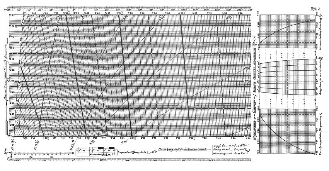
Bei Stahlaluminiumseilen dagegen ändern sich bei einem Wechsel des Seilaufbaues alle drei mitwirksamen Materialeigenschaften: elastische Dehnung, Wärme-Dehnung, Eigengewicht (für die Seilkombination als Ganzes). Mit einem einzigen Umrechnungsfaktor, wie bei Cu- und Al-Legierungen, ist hier im allgemeinen nicht mehr das Auslangen zu finden, wenn man anhand einer Singertafel für
