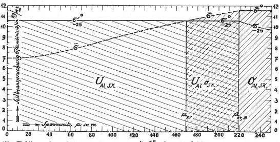
Abb. 2. Tiefstlemperatur - µ. Zusatzlast-Spannung für 49.50 Stahl-Al-Seil bei verschiedenen Spanweiten.
