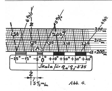
$\overline{A}_{-5}$ , der herabgelotet wird auf Punkt  $A_{-5}$  (Abb. 4) <sup>23</sup>); hier ist (mit Skalenpunkt  $-5^{0}$ ) die entsprechend (mit  $F_{\rm t}=0.93$ ) umgerechnete bzw. aus dem Hilfsdiagramm Tafel I (für n=3.35) unmittelbar abgegriffene Temperaturdifferenzenskala anzulegen; damit können wir ablesen die scheinbaren Durchhangsprozentsatzwerte  $\varphi_{\rm Ta}$ :
