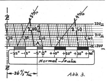
Die vorliegende Spannweite ist somit oberkritisch d. h.: Höchst-Aluminiumbeanspruchung und Höchstseilzug treten auf bei Zusatzlast, Ausgangsspannung  $\overline{\sigma} = \overline{\sigma}^{\circ}_{(G.)} = 9.53 \text{ kg/mm}^2.$
