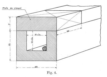
Ce canal est recouvert sur toute sa longueur au moyen de plots en ciment de 40 cm de longueur sur 20 cm de largeur et 7 cm d'épaisseur. Cette couverture, très solide, peut résister aux coups de pioche qui pourraient éventuellement l'atteindre. Pour rendre le canal parfaitement étanche, chaque plot a été scellé au canal ainsi qu'aux plots voisins.
