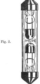
Zündspannung — diese kann nach Belieben durch Verändern der Gasdichte festgesetzt werden —, so wird das Edelgas ionisiert und die Patrone dadurch sofort zu einem sehr guten Leiter. Die Ueberspannung wird abgeleitet, die Spannung sinkt; die Entladung ist erst bei Erreichen der sog. "Löschspannung" beendet. Diese ist stets niedriger als die Zündspannung. Im Gegensatz hierzu kann bei Kohleblitzableitern der Lichtbogen bei Berührung einer Starkstromleitung fortdauern.
