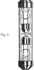
Zündspannung — diese kann nach Belieben durch Verändern der Gasdichte festgesetzt werden —, so wird das Edelgas ionisiert und die Patrone dadurch sofort zu einem sehr guten Leiter. Die Ueberspannung wird abgeleitet, die Spannung sinkt; die Entladung ist erst bei Erreichen der sog. "Löschspannung" beendet. Diese ist stets niedriger als die Zündspannung. Im Gegensatz hierzu kann bei Kohleblitzableitern der Lichtbogen bei Berührung einer Starkstromleitung fortdauern.
