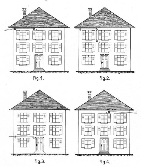
unter normalen Verhältnissen von der letzten Eisenkonsole weg bis zur Einführungsöffnung geradlinig, entweder nur horizontal oder nur vertikal zu führen, und dies in tunlichst geringem Abstand.
