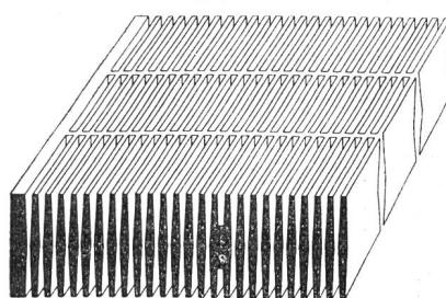
Fig. 3. Positive Platte, Querschnitt. — Plaque positive en coupe.
