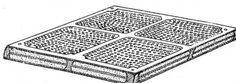
Fig. 5. Negative Platte, Querschnitt. — Plaque négative en coupe.
