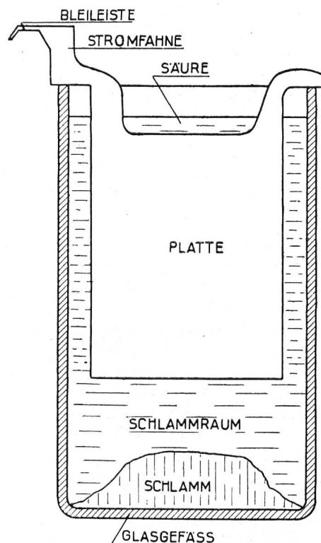
Fig. 9. Aufhängung der Platten. — Manière de suspendre les plaques.
