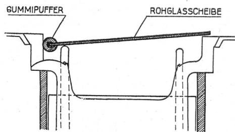
Fig. 12. Abdeckung mit Glasplatten. — Couvercle en verre.
