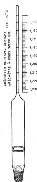
Fig. 23. Aräometer, flach. Fig. 24. Säureprüfer, grosses Modell.
