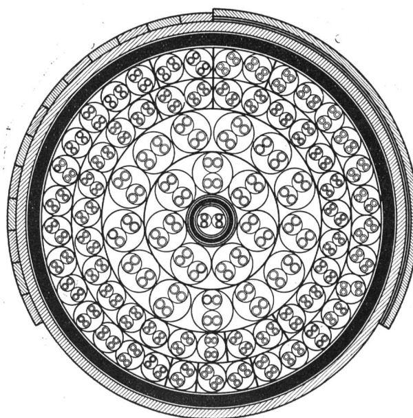
Fig. 28. Querschnitt des Kabels mit 81 Vierern.
