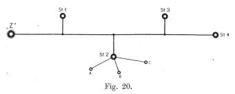
In Fig. 20 ist eine solche Anlage schematisch dargestellt. Die Teilnehmer 1, 3 und 4 besitzen einfache Einrichtungen, Teilnehmer 2 hat einen Hauptumschalter mit 3 angeschlossenen Zweigstationen A, B, C.
