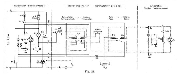
tung von Bedienungsstation, Hauptumschalter und Zweigstation ist aus Fig. 21 ersichtlich. Wie daraus hervorgeht, besteht die Zweigleitung (Verbindungsleitung Hauptstelle-Zweigstation) aus zwei Drähten. Das Auslegen eines dritten Drahtes kann durch Verwendung eines Wechselstromrelais (WR) vermieden werden.
