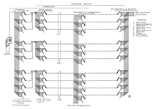
Fig. 24. Plan schématique des circuits de jonction.
