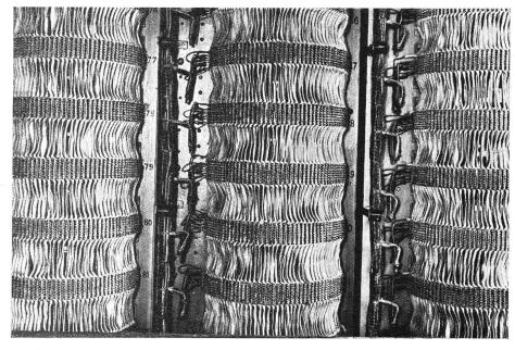
Fig. 21. Câblage multiple à isolation de soie.
