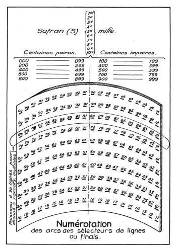
Fig. 20. Numérotation de l'arc des sélecteurs de lignes.
