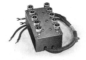
Fig. 26. Clavier pour l'envoi des numéros par les opératrices.
