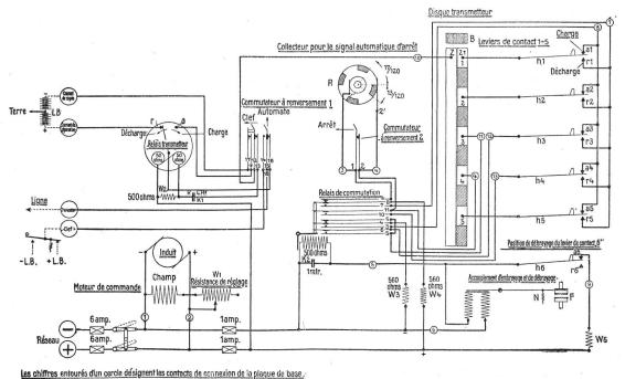
Fig. 9. Vollständiges Schaltbild des Senders. — Schéma du transmetteur.
