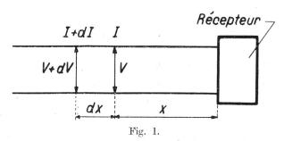
Si sur la ligne (voir fig. 1), nous avançons d'une petite longueur dx en nous éloignant du récepteur, la différence de potentiel croît d'une quantité égale au produit de l'intensité par l'impédance du segment de ligne parcouru. Appelons dU cet accroissement; on a
