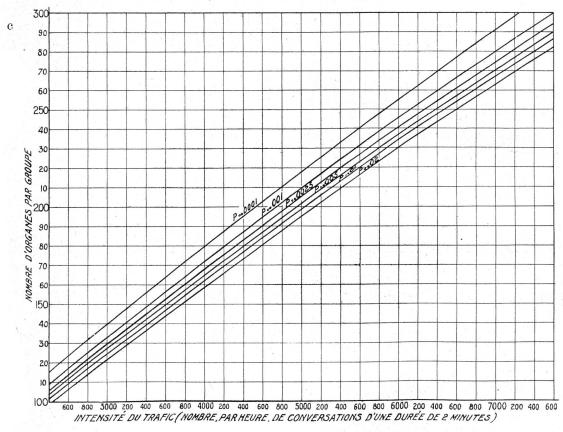
Fig. 4 a, b, c. Courbes de la Bell Telephone Manufacturing Company, Anvers, donnant en fonction de l'intensité du trafic le nombre d'organes nécessaires pour assurer une probabilité des appels en surnombre de 0,0001, 0,001, 0,0025, 0,005, 0,01, 0,02, et tracées d'après la formule
