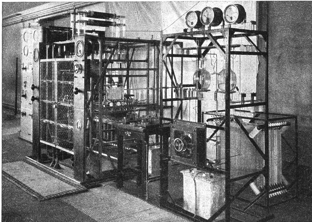
neuen Sendeanlage ist zusammengesetzt aus einem Kupfergestell, an dem die Instrumente und Zubehör befestigt sind, wie die Schwingungsröhre, Selbstinduktionsspulen und Kondensatoren. Besonders hervorzuheben ist die Senderöhre, weil sie einen der interessantesten Fortschritte der Radiotechnik darstellt.
