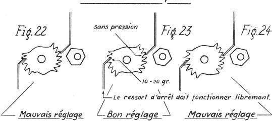
de propulsion, qui est solidaire de l'armature, doit buter l'hexagone d'arrêt avant que le téton de l'armature touche le noyau.
