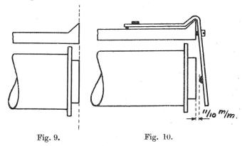
Pour la vérification des lamelles au moyen du comparateur, il faut que la tension du ressort à contrôler équilibre exactement celle du comparateur convenablement réglé. La tolérance de réglage des tensions est ordinairement de 2 à 5 grammes.
