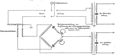
Fig. 9 Nebensprechmesseinrichtung. Obenansicht und eine Schaltungsart.
