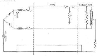
Das Verfahren ist folgendes: In bestimmten Stufen wird für eine Anzahl von Frequenzen innerhalb des Frequenzbereiches von 200 bis 2000 Perioden das Brückengleichgewicht hergestellt und die Grösse und das Vorzeichen des Widerstandes und der Induktivität bestimmt, die im Brückenarm eingeschaltet werden müssen, um die Ungleichheiten in der Leitung zu kompensieren. Die so erhaltenen
