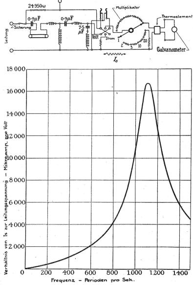
Fig. 8. Schaltschema und Eichkurve des Telephonstörungsfaktormesser der Spannungswelle.
