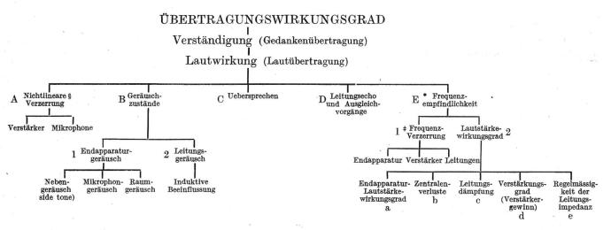
Fig. 5. Aufstellung der den Uebertragungswirkungsgrad beeinflussenden Faktoren.
