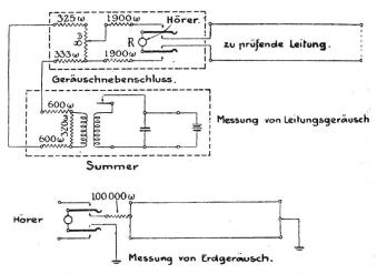
Fig. 6. Schaltschema der "1-A"-Geräuschmesseinrichtung.
