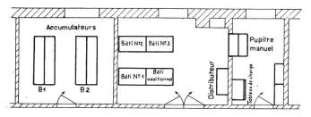
(Fig. 3) Plan de la centrale autom. du B.I.T.
