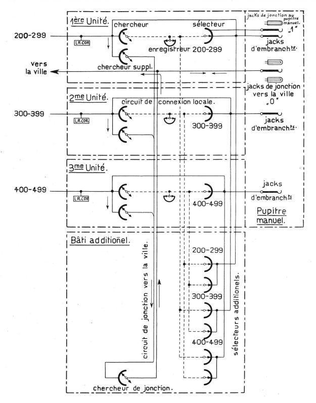
(Fig. 4) Diagramme de jonctions de la centrale automatique du B.I.T.
