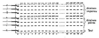
(Fig.5) - Numérotation de l'arc du sélecteur de la 1<sup>st</sup> unité.
