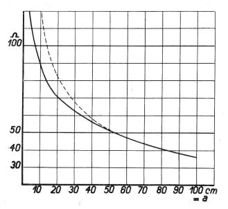
Die Widerstandskurve für rechteckförmige Platten verläuft bei unveränderlich angenommener längerer Seite zuerst rasch abfallend bis etwa zum Seitenverhältnis 5:1 (hier a = 20 cm), um sich dann in scharfer Biegung der geraden Linie zu nähern, wobei die Abnahme nur noch sehr langsam erfolgt.
