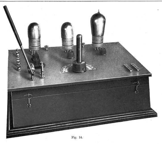
untersuchen, welche Schaltungsart bessere Resultate ergibt. Wird in den Gitterkreis eine Taschenlampenbatterie B bis zu 4,5 Volt eingeschaltet, so ist der Empfang um so reiner. Die beiden Niederfrequenztransformatoren müssen rechtwinklig zueinander angebracht werden, damit sie sich gegenseitig nicht beeinflussen.
