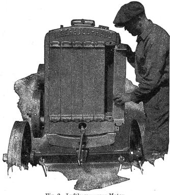
Fig. 2. Luftkompressor-Motor.
