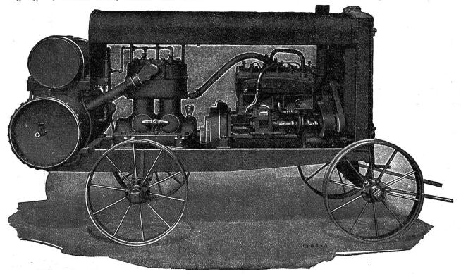
Fig. 1. Luftkompressor-Motor.
