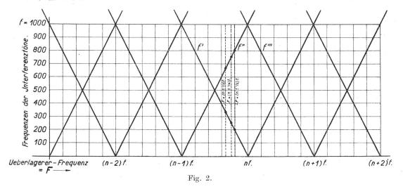
eingestellt werden. Nähert man sich der richtigen Einstellung nach und nach, so treten immer deutlichere und langsamer werdende Tonschwebungen hervor, die zuletzt leicht gezählt werden können und ausgeprägte Perioden von 2—3 Sekunden Dauer zeigen, bis sie ganz verschwinden.
