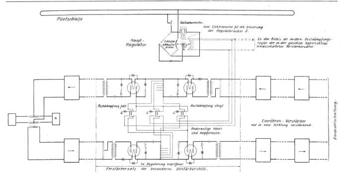
Fig. 15. Automatischer Restdämpfungsregler mit Pilotschleifen.
