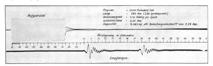
Fig. 12. Ausgleichvorgänge in einer 1,82 mm Kabelleitung mit "mittlerer" Belastung.
