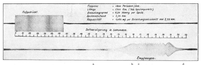
a b c Fig. 10. Ausgleichvorgänge in einer 1,82 mm Kabelleitung mit "mittlerer" Belastung.
