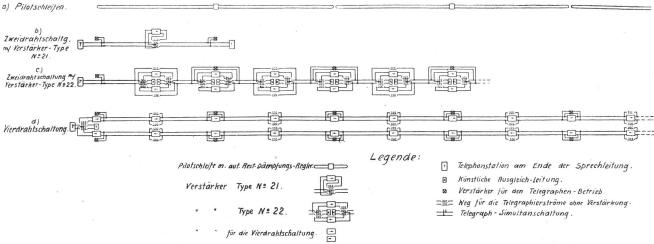
Fig. 1. Verschiedene Verstärkerschaltungen für Fernkabel.
