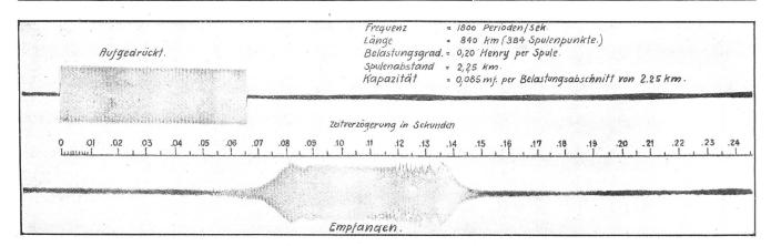
Fig. 11. Ausgleichvorgänge in einer 1,82 mm Kabelleitung mit "mittlerer" Belastung.
