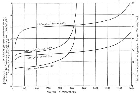
Fig. 2. Dämpfungs-Frequenzwerte für induktiv belastete Stammleitungen.
