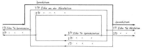
Fig. 3. Echobahnen in der Vierdrahtschaltung.
