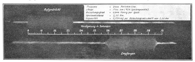
Fig. 13. Ausgleichvorgänge in einer 0,91 mm Kabelleitung mit "leichter" Belastung.
