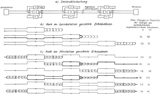
Fig. 4. Echobahnen bei Zweidrahtschaltung.
