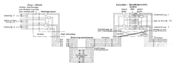
Fig. 8. Vierdrahtschaltung-Gruppierung der Leitungen zur Verminderung des Nebensprechens.
