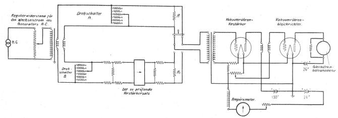
Fig. 14. Einrichtung zur Prüfung der Verstärkungsziffern von Vakuumröhren.
