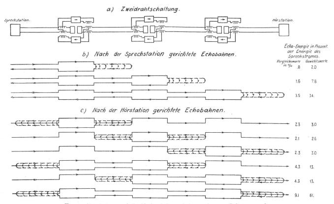
Fig. 6. Echobahnen auf Zweidrahtschaltung bei weggelassener Belastungsspule.
