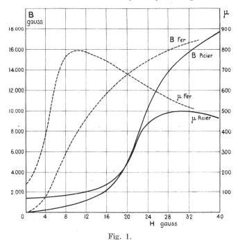
La figure 1 représente les courbes d'aimantation de l'acier et du fer. On voit que l'acier est caractérisé par une courbe dont la première partie parabolique relativement longue, s'étend jusque dans les champs de 10 à 12 gauss. Le champ coercitif de cet acier est d'environ 24 gauss, ce qui correspond à un acier doux.
