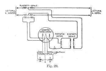
von sinusoidalen Strömen mit höhern oder niedrigeren Frequenzen als derjenigen der Sprechströme, welche von der gleichzeitigen Benützung der Telephonschleifen für Telegraphen- und andere Signalströme herrühren können, verhindert wird. Das Potentiometer ist zum Einstellen der Leistung des Verstärkers bestimmt. Die Verzögerungsspulen und Kondensatoren verhindern das Uebersprechen in benachbarte Telephonstromkreise und ermöglichen
