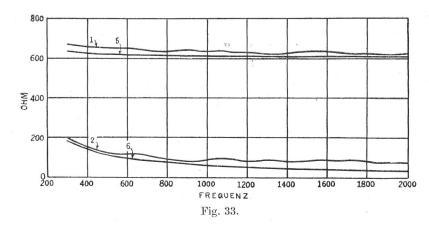
Impedanzbrücke von gleicher Beschaffenheit, wie sie ein langes Stück der Leitung selbst darstellen würde, am entgegengesetzten Ende geschlossen wurde, jedoch eine 2 km lange Kabelstrecke enthält, die 169 km vom Ende, an welchem die Messungen vorgenommen wurden, entfernt ist.
