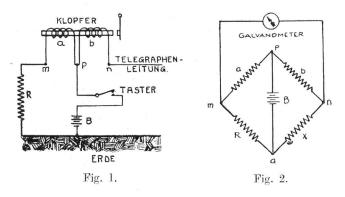
So haben wir in Fig. 1 eine frühere Anordnung für Gegensprech-Telegraphie dargestellt, welche augenscheinlich einer einfachen Brückenschaltung entspricht, wie Fig. 2 sie zeigt. Wenn a gleich b und wenn auch R gleich X ist, so ist die Potentialdifferenz der Batterie zwischen m und n gleich Null; somit fliesst im Falle der Fig. 2 kein Strom durch das Galvanometer, und es entsteht kein magnetisches Kraftfeld im Klopfer der Fig. 1.
