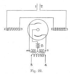
Der Elektromagnet befindet sich in der Ebene dieser Elektroden und dient somit dazu, die Strömung in der Hauptstrecke gegen die eine oder die andere Seitenelektrode abzulenken, je nach der Polarität des Magneten. Die Ionen der Hauptstrecke können als Stromträger zwischen diesen Elektroden und der Mittelelektrode dienen, wenn zwischen denselben eine Potentialdifferenz aufrecht erhalten wird, wie die Batterie B sie erzeugt.
