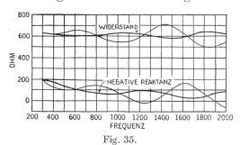
danzkurven vorgeführt, welche vom Einfluss der Unregelmässigkeiten im Impedanzcharakter zeugen. Der Einfachheit halber seien für diese Kurven nur die Widerstandskomponenten angeführt, da die Reaktanzkomponenten bedeutend kleiner sind und übrigens annähernd den gleichen Verlauf nehmen wie die Widerstandskurven.
