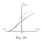
Bei richtiger Bemessung des äussern Widerstandes des Stromkreises Platte—Heizdraht ergibt sich eine ausgesprochen geradlinige, charakteristische Beziehung zwischen Gitterspannung und Plattenstrom, welche in Fig. 20 durch die ausgezogene Kurve dargestellt ist.
