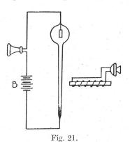
gezeigte Röhre enthält Quecksilberdampf, durch welchen ein Strom aus der Batterie B hindurchgeht. Ein Hörer ist mit der Batterie und der Bogenstrecke in Reihe geschaltet. Die Strömung in der Bogenstrecke wird durch den Elektromagneten beeinflusst, welcher seinerseits durch das Mikrophon erregt wird. Diese Anordnung, welche einen sehr unempfindlichen, einseitig wirkenden Verstärkerapparat darstellt, ist, soviel bekannt, im Telephonverstärkerbetrieb niemals zur Anwendung gekommen.
