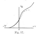
Die Spannungen im Audion bei Radioempfang von telegraphischen Zeichen sind bedeutend kleiner als die in der Telephonie gebräuchlichen, weshalb durch Gasresten keine Unzukömmlichkeit entsteht. Aus diesem Grunde fand es De Forest nicht für notwendig, alle die bekannten Mittel anzuwenden, durch welche ein möglichst hohes Vakuum erzeugt werden
