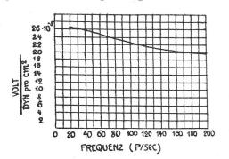
Fig. 9. Wirkungsgrad des Kondensatormikrophons.
