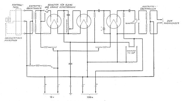
Fig. 11. Schaltungsschema des Eintrittverstärkers.
