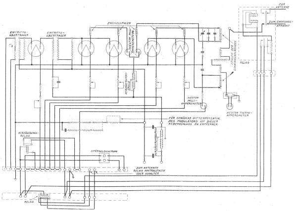
Fig. 15. Stromkreis-Diagramm des Radiosenders.
