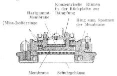
Fig. 6. Querschnitt durch das Kondensatormikrophon.
