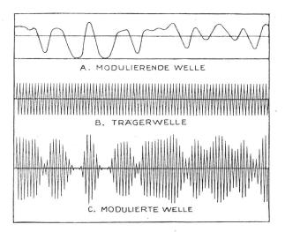
Fig. 18. Schematische Darstellung des Modulationsvorganges.
