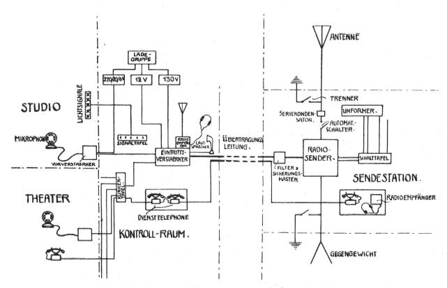
Fig. 20. Gesamtes Verbindungsschema der Radiostation Zürich.
