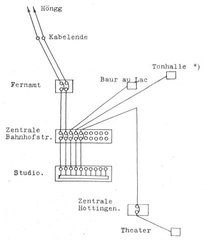
Fig. 3. Schematische Darstellung der Fernbesprechungs-Anlage.
