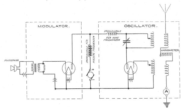
Fig. 19. Modulationsprinzip des Senders.
