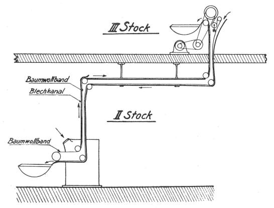
Fig. 8. Skizze der Förderbandanlage Sortierer-Telegrammkontrolle.
