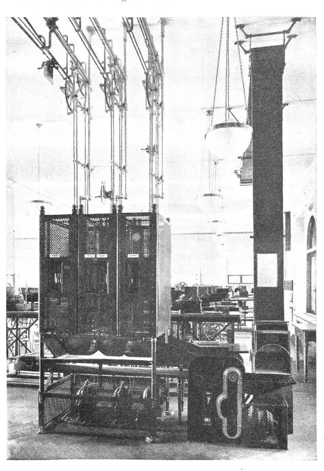
Fig. 1. Seilpost- und Förderbandzentralstation (Vorderansicht).
