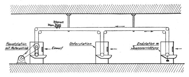
Fig. 7. Skizze eines Seilpostanlagestranges mit Antriebstation, Unterstation und Spannstation.
