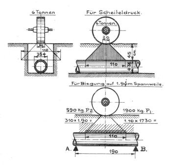
Diese Lasten erzeugen bei freier Auflagerung des Rohres und einem Abstand zwischen den Stützen von 1,90 m ein maximales Biegungsmoment von
