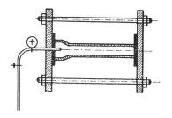
Während die maschinell und handgestampften Röhren vor ihrer Schlemmung mit Zementbojake und Anstrich mit einem Dichtungsmittel selten der Vorschrift (0,3 Atm.) genügen, hat die Prüfung von handgegossenen unarmierten Röhren bis 0,5 Atm./½ Std. und die der geschleuderten armierten Vianiniröhren bis 4 Atm. auf die Dauer von 2 Stunden ergeben.
