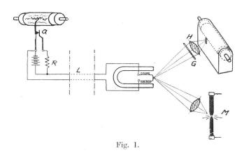
stückes. Trifft er auf eine erhabene, also auf eine beschriebene Stelle, so wird er etwas gehoben. Dadurch wird der Kontakt a unterbrochen und der zur Leitung L parallel geschaltete Widerstand Rausgeschaltet, sodass die Leitung den Gesamtstrom aus der Batterie erhält. Die Uebermittlung eines Telegramms erfordert 5—12 Minuten. Je nach dem
