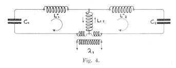
schaltet sind und die Selbstinduktion um den Betrag des Kopplungsfaktors vermindert ist.
