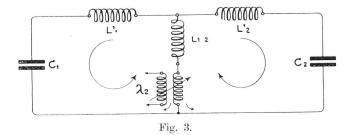
Man erkennt ohne weiteres, dass ein solches System fähig ist, in zwei verschiedenen Frequenzen in Resonanz zu schwingen. Wird der Kreis im Brückenzweig  $L_{12}$  induziert (Zahnradkopplung) (Fig. 3), so bestehen zwei parallel geschaltete Schwingungskreise mit gemeinsamer Selbstinduktion  $L_{12}$ . Die Wellenlänge ist also grösser als die der Grundwelle.
