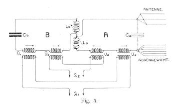
spulen der zwei Energie-Uebertragungs-Transformatoren  $\dot{U}_1$  und  $\dot{U}_3.$
