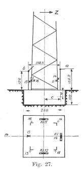
Nr. 11, 13, 14, 15 und 16: Stoppani-Messuhren, Messgenauigkeit  $^{1}/_{100}$  mm. Kl. 11, Kl. 12 und Kl. 14 = Klinometer 1 Teilstrich = 1,2". (Klinometer 14 defekt.)
