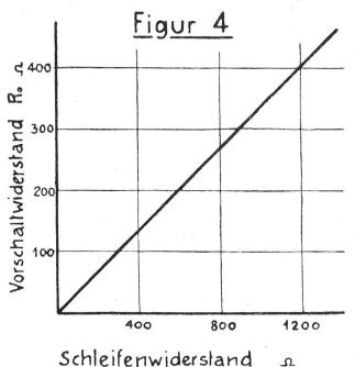
Wert von 600 Ohm entspricht nach Figur 4 einem Schleifenwiderstande von 1800 Ohm. (Die Widerstände müssen aus Material mit einem möglichst kleinen Temperaturkoeffizienten hergestellt werden, damit durch eventuelle Temperaturänderungen keine
