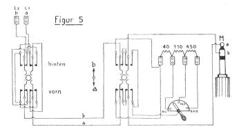
an der Messstation liegt, dass eine Kontrollmessung nicht mehr möglich ist, so schaltet man auf dem betr. Draht (in Stellung a auf Draht a und in Stellung b auf Draht b) den nötigen Widerstand (z. B. 40, 150 oder 600 Ohm) vor, bis man eine Kontrollmessung ausführen kann.
