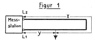
Durch Linienumkehr (Vertauschen der Zuleitungen  $L_1$  und  $L_2$  in Figur 1) erhält man den Wert für y. Die Summe von x+y soll dann den gemessenen Widerstand W ergeben; man hat darin eine Kon-
