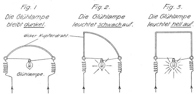
Vom Hochfrequenz-Induktorium mit einem Blitzschutzapparat als Funkenstrecke.
