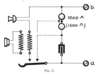
lung gebildet (bei Schaltungen unserer Verwaltung 1000 Ohm) oder, bei der Ausführung mit 1500 ohmigem Wecker, durch die halbe Weckerwicklung (750 Ohm).
