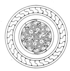
Tiefseekabel mit  $7 \times 4$  Fernsprechleitungen und  $6 \times 2$  Telegraphenleitungen.
