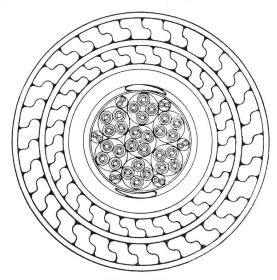
Küstenkabel mit  $7\times4$  Fernsprechleitungen und  $6\times2$  Telegraphenleitungen.
