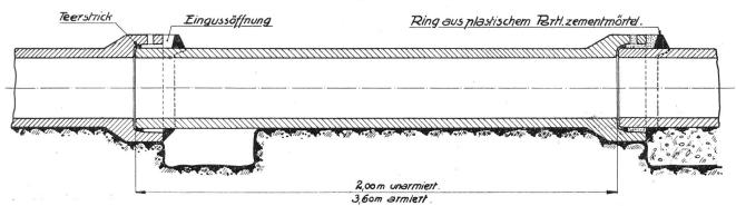
Bei der Verlegung von Hunzikerröhren (Fig. 4) kann es leicht vorkommen, dass Mörtel in das Rohrinnere gepresst wird. Solche Mörtelbrauen müssen unverzüglich mittelst der Rohrbürste entfernt werden. Letztere ist an Eisenstangen so zu befestigen, dass immer noch der zweitle tzte Rohrstoss ausgebürstet werden kann. Mit dem Ausgiessen des Stosses darf erst begonnen werden, nachdem das gut dichtende Mörtelband vollständig erhärtet ist.
