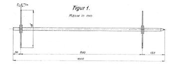
3 mm starken kreisrunden Blechscheiben, die in einem Abstande von ungefähr 80 cm auf einem Eisenstabe oder Gasrohr genau zentrisch festsitzen. Der Durchmesser der Scheiben ist 2—3 mm kleiner als der nach unten tolerierte Rohrdurchmesser.
