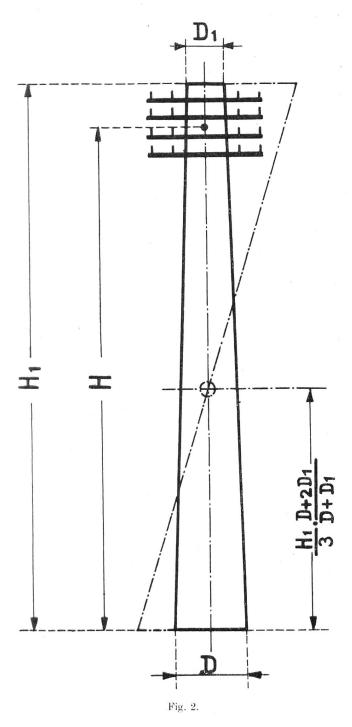
Spannweite in m, H die mittlere Drahthöhe über Boden in m und  $H_1$  die gesamte Stangenlänge über Boden in m. Der Winddruck auf die Drähte wird nun  $W_d = 50~\Sigma d~S~kg$ .
