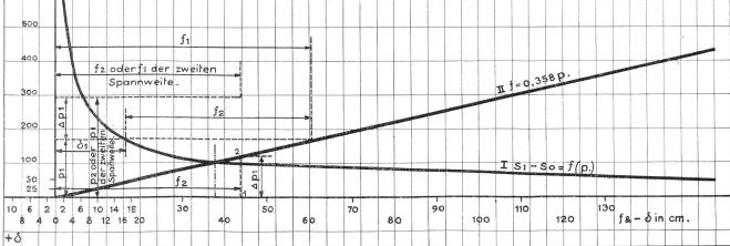
Wenn  $p_1$  als Ordinaten und  $S_1$ — $S_0$  als Abszissen aufgetragen werden, so ergibt sich die in Fig. 4 dargestellte Kurve I. Anderseits beträgt die Durchbiegung der Tragmaste
