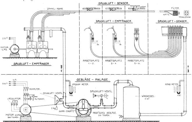
Fig. 1. Schematische Darstellung einer Rohrpost-Anlage.
