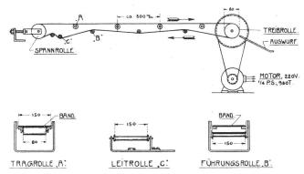
Fig. 9. Transportbandanlage (Schematische Anordnung).
