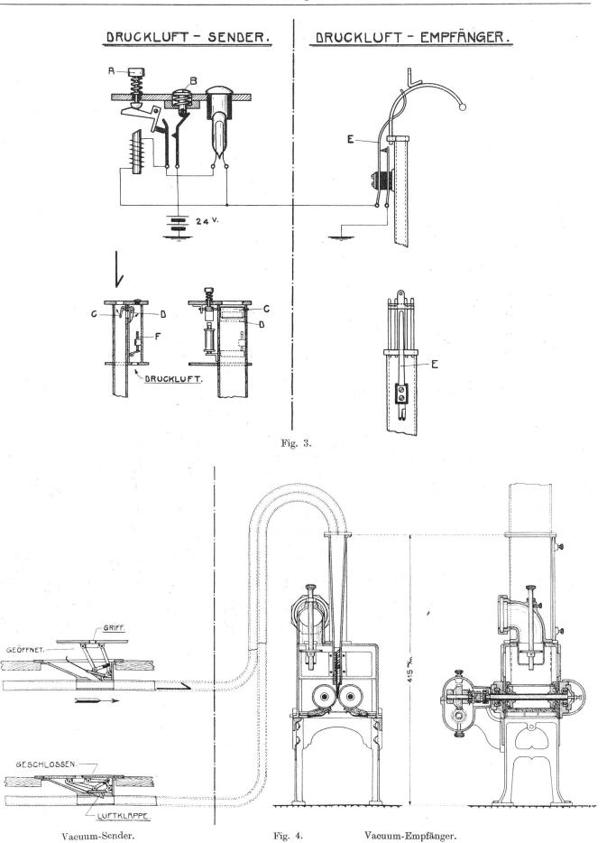
nach den Druckluftsendern weiter getrieben. Wenn in den Saugrohrleitungen irgend eine Verstopfung eintreten sollte, so öffnet sich das Saugluftventil, dessen Trichter mehrfachen Tuchüberzug zur Reinigung der eingesaugten Luft besitzt.
