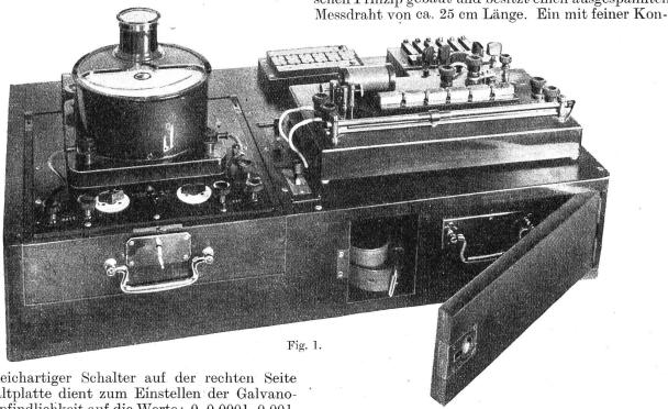
Ein gleichartiger Schalter auf der rechten Seite der Schaltplatte dient zum Einstellen der Galvanometerempfindlichkeit auf die Werte: 0, 0,0001, 0,001, 0,01, 0,1 und 1.
