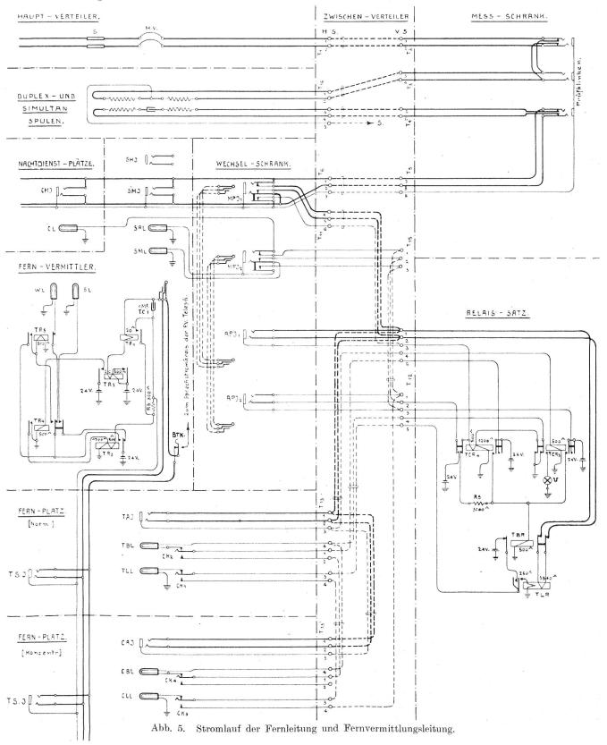
Diese Wechselschaltung bietet den betriebstechnischen Vorteil, dass das Umlegen einer Leitung die Klinken und Lampen im Fernvermittlungsschrank und im Nachtfernschrank unbeeinflusst lässt. Es können also in den verkehrsstärksten Stunden beliebige Umschaltungen vorgenommen werden, ohne dass die Fernvermittlungstelephonistinnen dies merken. Nur die Telephonistin, die nunmehr die Leitung bedient, braucht benachrichtigt zu werden.
