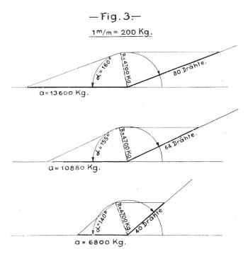
Für  $10 \times 8$  Drähte ist a = 13600 kg u. Winkel  $a = 160^{\circ}$ . Für  $8 \times 8$  Drähte ist  $a = \frac{64}{80} \times 13600 = 10880$  kg
