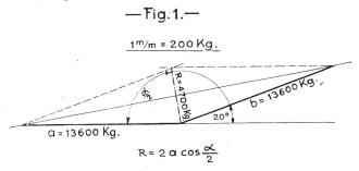
'Diese Zugbeanspruchung soll beidseitig auf ein 10 m Doppelgestänge wirken, und wir wollen nun untersuchen, ob eine einzige Strebe bei der normalen Ausladung der halben Stangenhöhe die nötige Druckund Knickfestigkeit besitzt.
