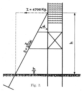
und da die Ausladung der Strebe bei Normalkonstrukionen gleich der halben Masthöhe sein soll, so wird tg. Winkel  $a=\frac{h}{2~h}=0.5$ , folglich sin Winkel  $a\sim0.45$  und somit die Druckkraft auf die Strebe  $=\frac{4700}{0.45}\sim 10\,500~{\rm kg}.$
