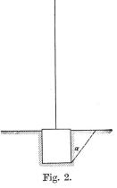
Einspannung gar nicht. Später wurde dieser letztern in der Weise Rechnung getragen, dass zum Gewicht des Fundamentblockes noch dasjenige eines innerhalb eines bestimmten Böschungswinkels seitlich daran anliegenden Erdkeiles hinzugerechnet werden durfte. Um die in Frage kommenden Verhältnisse näher
