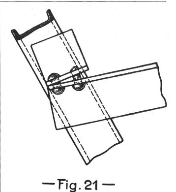
Stange Nr. 7 kann nicht verglichen werden, da der Stangenbruch nach Abscheren der Kreuz-Befestigungsbolzen erfolgte; folglich wird e grösser als  $\frac{1840}{590} = 3,12$ . In Versuch Nr. 8 erreicht  $c_2$  den Wert  $\frac{1800}{1800} = 3,1$ . Die letzte Probe, Doppelstange mit
