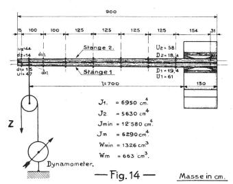
Auch bei diesem Versuch zeigt sich, dass die Kuppelschrauben die gegenseitige Verschiebung der Stangen nicht verhindern können. Trägheits- und Widerstandsmoment sinken daher fast auf den minimalen Wert. Die 8 Schraubenbolzen vermögen keine wesentliche Verstärkung zu erzeugen. Der Verstärkungsfaktor ergibt sich hier durch Vergleich Verstärkungslaktor eigibt sich  $\frac{1}{590}$  der Bruchbelastungen zu  $C_2 = \frac{1420}{590} = 2,4.$
