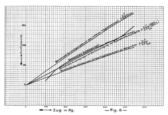
590 kg einseitigem Zug erfolgte Bruch der Stange an der Einspannstelle lässt an dem Bruchquerschnitt die Zug- und Druckfasern deutlich erkennen.
