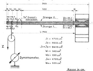
Das theoretische maximale Trägheitsmoment einer Kuppelstange beträgt 10  $\frac{\pi}{64}$  cm<sup>4</sup>, vorausgesetzt, dass die beiden Stangen den gleichen Durchmesser aufweisen. Das Minimum desselben ist 2  $\frac{D^4}{64}$  cm<sup>4</sup> und ist gleich der Summe der einzelnen Stangen-
