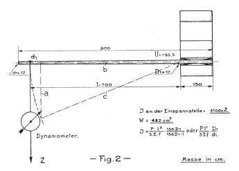
Die Resultate des Versuches Nr. 1 sind sehr ungenau und zu Vergleichszwecken fast unbrauchbar. Einmal sind die Angaben des Dynamometers im untern Bereich unrichtig und zweitens nimmt der Elastizitätsmodul des verwendeten Holzes von Beobachtung Nr. 15 an sehr rasch ab. Diese Abnahme ist aus den Schaulinien für das Trägheitsmoment, die Ausbiegungen und das Elastizitätsmass (Fig. 3) deutlich zu erkennen. Für einen bestimmten Quer-
