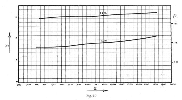
Aenderung der Dämpfung in Abhängigkeit von der Frequenz.
