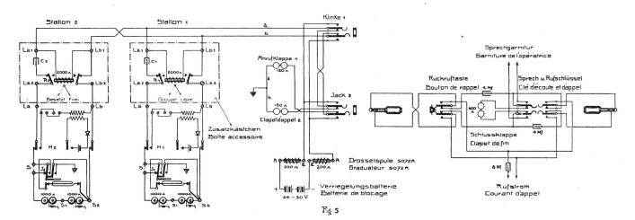
hören möglich. Gleichzeitig nimmt das optische Signal die Besetztstellung ein. Die Elektromagnete sind derart gewickelt, dass, wenn die Klemme La 1 mit dem positiven und die Klemme Lb 1 mit dem negativen Pol verbunden wird, der Anker seine Ruhelage behält.
