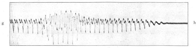
Man kann der Kurve ohne weiteres entnehmen, dass man es hier mit Wechselstrom hoher Periodenzahl zu tun hat. Die Bilder der einzelnen Silben zeigen für den grössten Teil ihres Bereiches eine periodische Form. Bei der telephonischen Uebermittlung der Sprache handelt es sich um Uebertragung kleiner Energien. Je nach Empfindlichkeit der Hörer der Empfangsapparate genügen Leistungen von  $0,1.10^{-6}$  bis  $15.10^{-6}$  Watt, um die übermittelte
