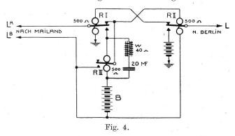
Parallel zum Relais RIII ist ein induktiver Widerstand W, sowie eine durch Kondensatoren gebildete künstliche Kapazität angeschlossen (Widerstand W und Kondensatoren unter sich hintereinander geschaltet). Die verhältnismässig grosse Kapazität von 20 Mf und der Widerstand W haben den Zweck, die zum richtigen Funktionieren der Entladevorrichtung nötige Verzögerung (Phasenverschiebung) des Relais RIII gegenüber dem Relais RI herzustellen.
