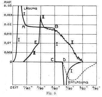
ungefähr die gleiche steil ansteigende Form auf, wie die Ladespitze. Ohne Entladevorrichtung würde die Entladekurve durch die Selbstinduktion der Wicklung des Relais RII stark abgeflacht und in die Länge gezogen (punktierte Kurve).
