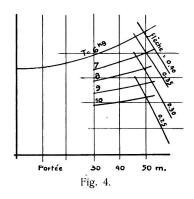
L'abaque Blondel est très utile aussi parce qu'il permet de déterminer également l'augmentation de tension résultant d'une surcharge. M. Blondel a fait remarquer, en effet, que toute surcharge se traduisait par une augmentation du poids spécifique  $\omega$  du fil qui passe à  $\omega'$ .
