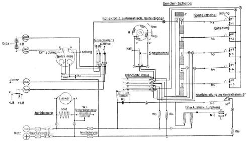
Die mit einem O umschriebenen Zahlen bezeichnen die Anschluss-Kontakte der Grundplatte
