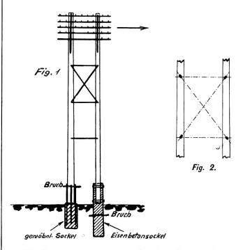
Die Stangenfüsse mit angeschraubten Stangen haben den Nachteil, dass die Stange an der Einspannstelle durch das Bolzenloch geschwächt wird. Im weiteren sind die an der Verwendungsstelle fabrizierten Betonsockel bei Verlegung einer Linie als Abbruchmaterial zu buchen. Immerhin kann das U-Eisen durch einen Sprengschuss freigelegt und teilweise wieder verwendet werden.
